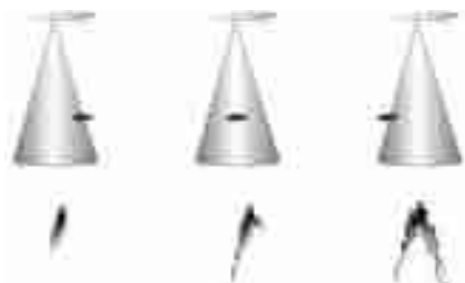
Cono del trasduttore e archi dei pesci
